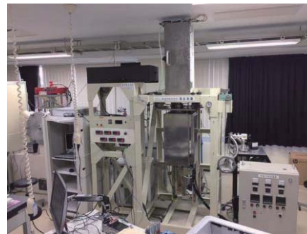
粘性率測定試験装置 高温金属融体の粘性率を測定できる装置は国内で殆どありません。
