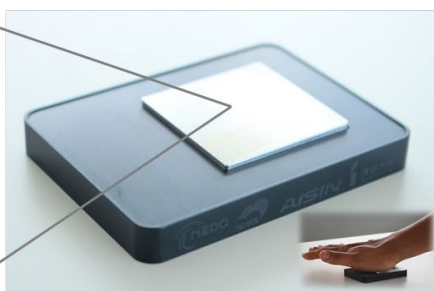
図2 IoT機器の試作機(温度・湿度センサー・BLE通信機器を内蔵した温度差駆動の自立電源システム)と、データ受信状況
