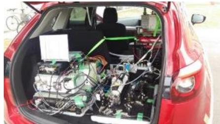
排気中のアンモニア車載計測の様子
