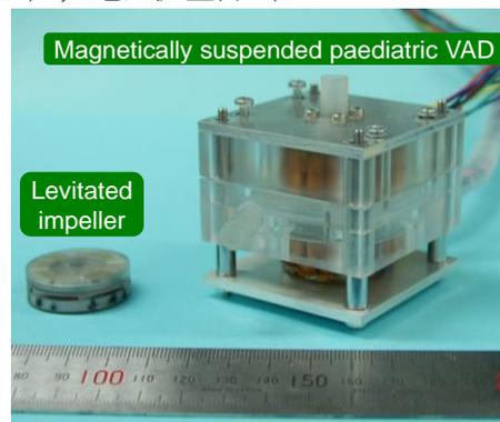
Fig.6 製作した小児用磁気浮上人工心臓
