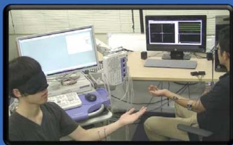
ヒト→ヒト運動伝達インタフェース 誤識別防止型動作推定
