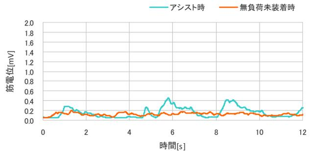
図 9 アシスト時と無負荷時の筋電位の比較
