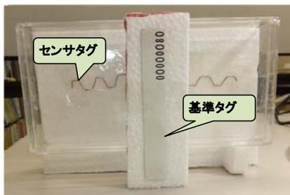
図-8 実験に使用した傾斜/振動センサタグ
